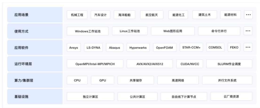
图 2 基于高性能计算云的工业仿真平台
